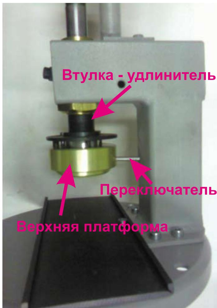
Станок состоит из станины и сменных насадок - платформ для значков различных диаметров. Для некоторых сменных насадок требуется втулка - удлинитель.
