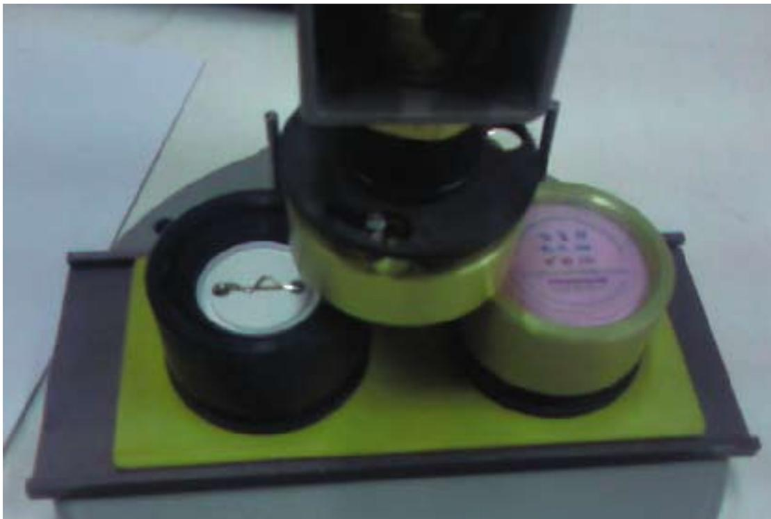
Нижнюю платформу с уложенными заготовками отодвигаем влево. Правый стакан перемещается под верхнюю платформу. Опускаем рычаг с усилием, необходимым для того, чтобы подпружиненный нижний стакан опустился до шайбы. Поднимаем рычаг. Лицевая часть заготовки теперь находится в полости верхней платформы.
